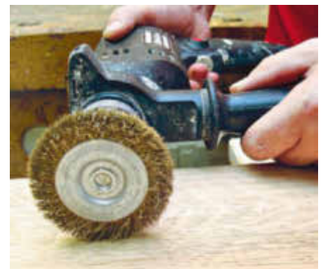
Für kleinere Flächen kommt die Bohrmaschine mit einer messingbeschichteten Stahldrahtbürste zum Einsatz
