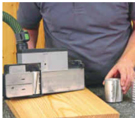
Mit entsprechenden Wellenmessern erschließt der Elektrohobel neue Einsatzbereiche in der Oberflächengestaltung
