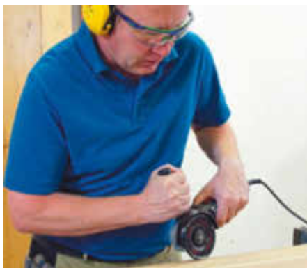
Langsam eintauchen und den Faserverlauf beachten, um Oberflächen »wie geschnitzt« mit dem Winkelschleifer zu erzeugen
